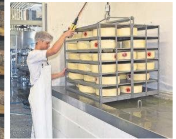
Les meules sont plongées dans de la saumure pour former la croûte.
