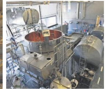
Le lait est directement acheminé dans cette grande cuve pour le «caillage».
