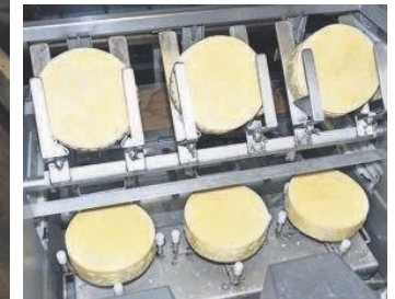
Un robot retourne les meules en cours d'affinage, encore claires sans les herbes.
